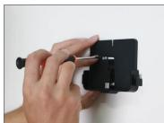
Ajustez la position de la base de montage et serrez les vis.
